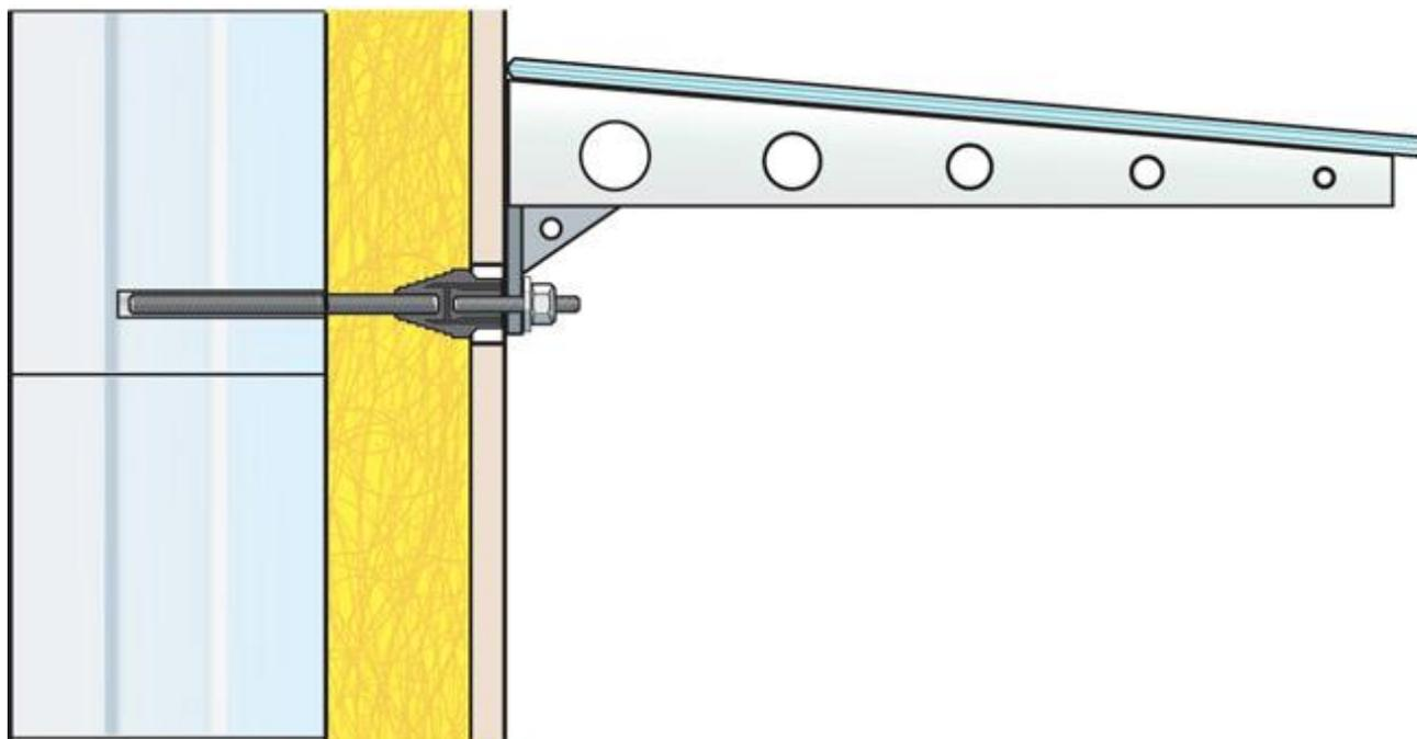
Per edifici rivestiti da cappotto è previsto il tassello Thermax dal gambo lungo ed isolato in modo da evitare la formazione di ponti termici.
