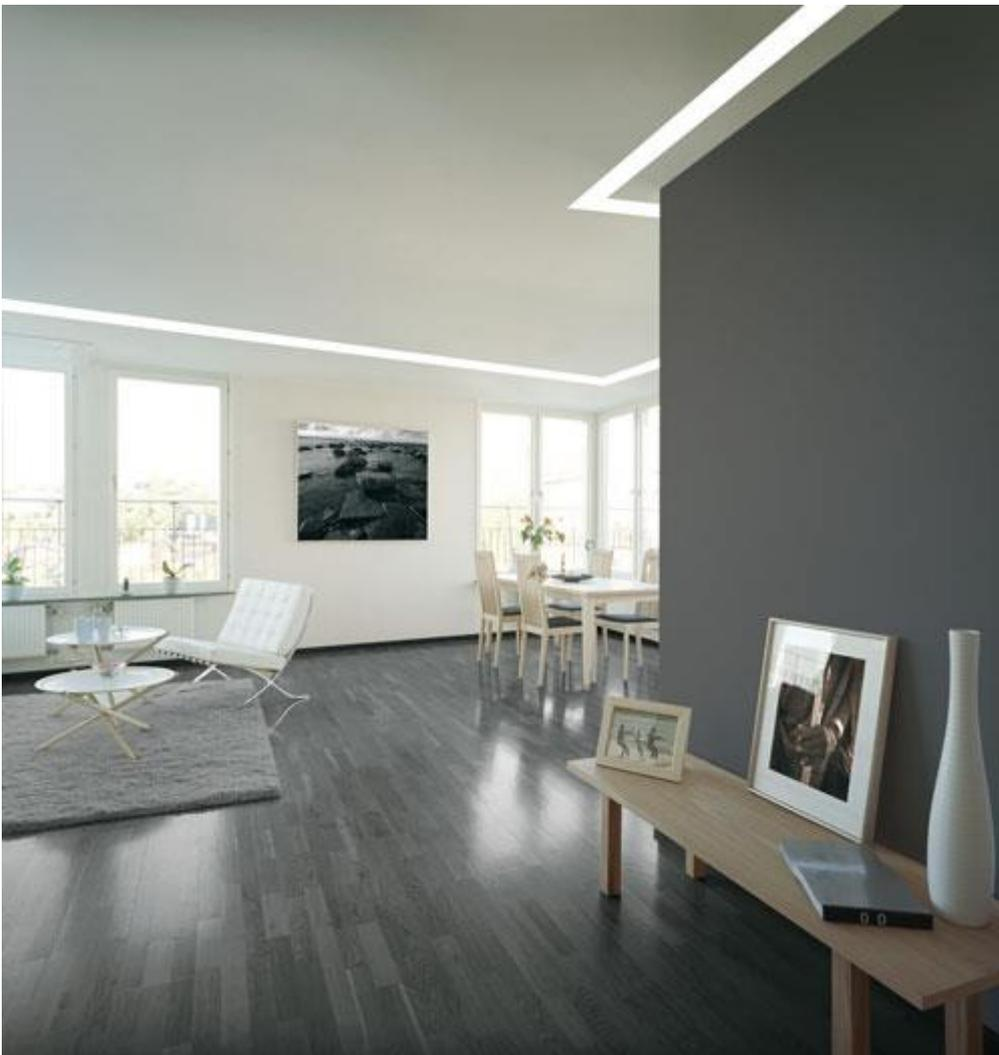
Nuovi profili da incasso permettono di incorporare luci al neon o a led a filo di pareti e soffitti di cartongesso, per illuminare gli ambienti in modo inusuale: sembra che siano le stesse superfici a dar luce al locale. Volendo, è possibile tinteggiare il profilo che ospita la fonte luminosa nella stessa
