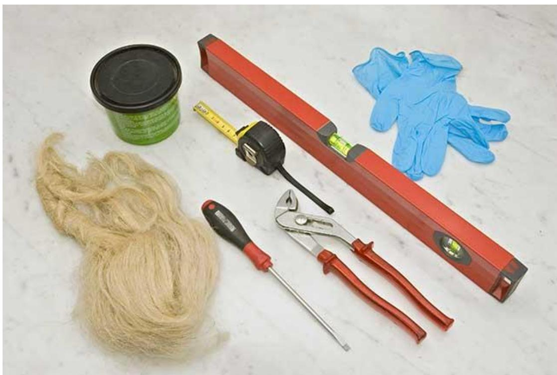
Tutto ciò che serve per la sostituzione: un cacciavite a taglio o a croce, una pinza a pappagallo, un metro, una livella, canapa e pasta per idraulica, un paio di guanti usa e getta.
