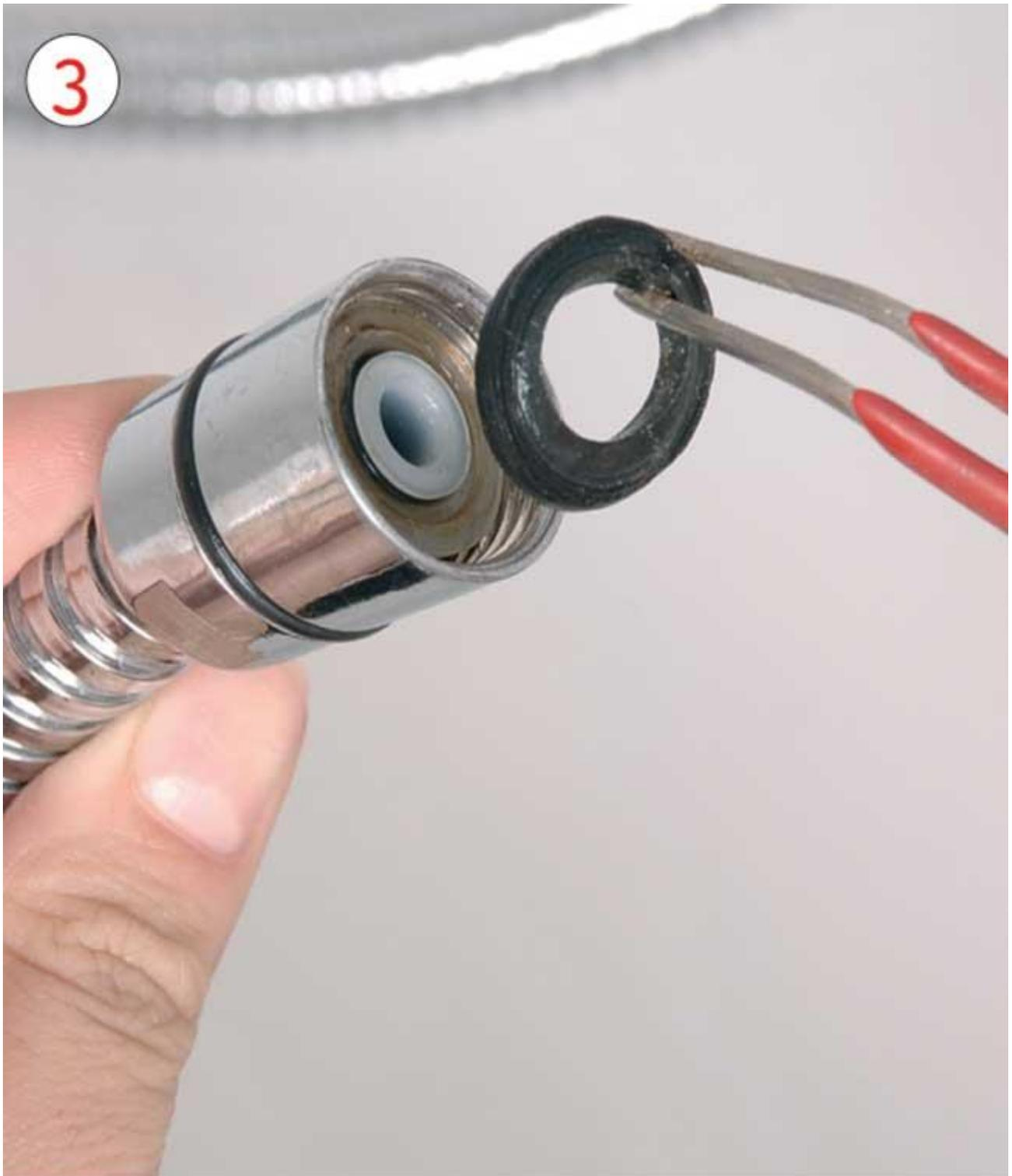
Alle due estremità del flessibile vi sono delle **guarnizioni anulari** che vanno sostituite.
