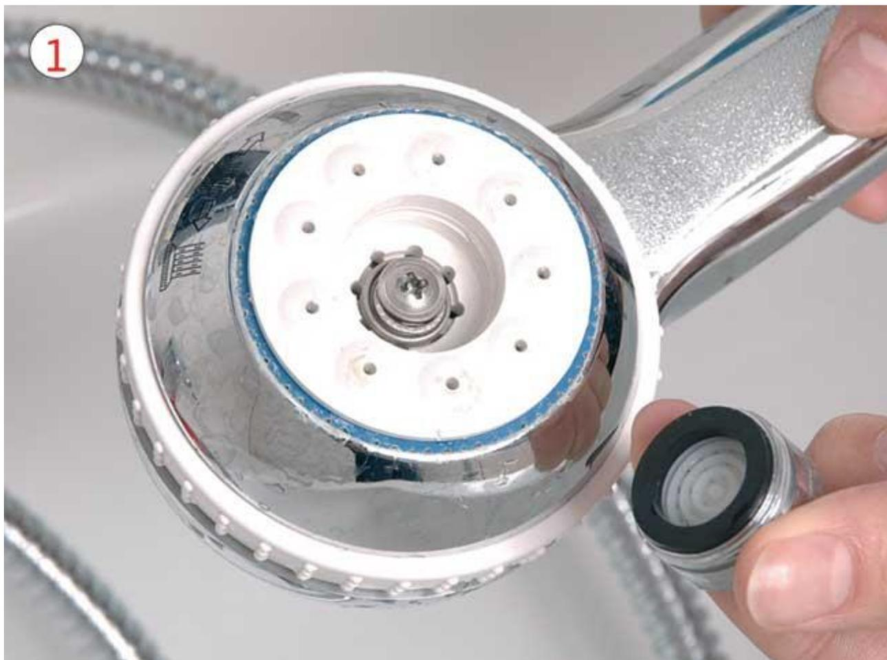
Il calcare che si deposita nei forellini e nei filtri delle **doccette** è in grado di ridurre notevolmente il deflusso dell'acqua e rendere irregolare il getto. Se notiamo malfunzionamenti di questo tipo dobbiamo smontare il soffione della doccia. I modelli sono molto diversi uno dall'altro: molti, come quello visibile in foto, hanno una **ghiera anulare** che può essere ruotata in varie posizioni per modificare la forma del getto.
