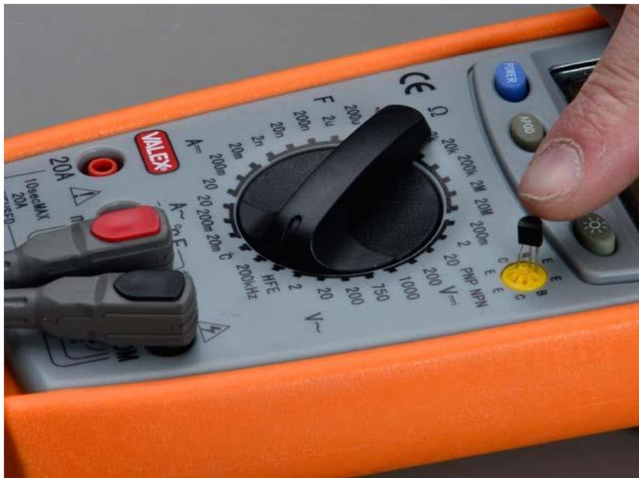
L'apparecchio provvede a fornire all'elemento da esaminare una corrente adeguata e rileva se le uscite sono corrette.
