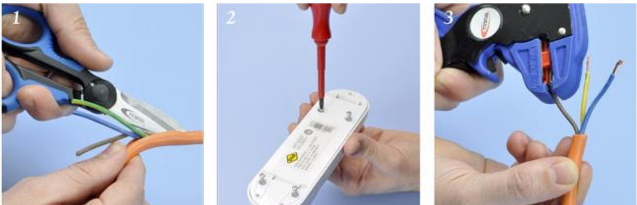
1. con le forbici da elettricista incidiamo la guaina esterna del cavo elettrico in modo da portare in evidenza i conduttori interni (fase, neutro, terra).
