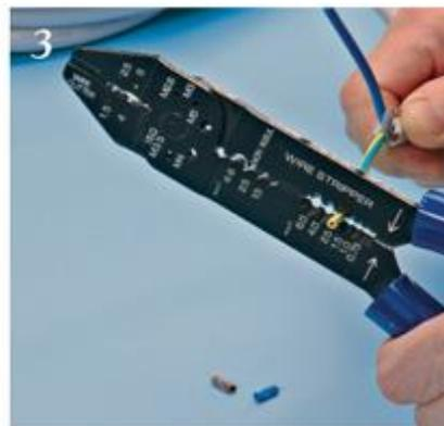
1. la preparazione dei conduttori della prolunga elettrica prevede l'eliminazione della guaina esterna con **pinze spellacavi** o praticando con cautela piccole incisioni con la punta delle forbici.
